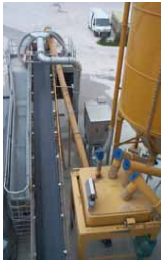
Weigh hopper loaded by screw feeder Behälterwaage durch Dosierschnecke befüllt Trémie alimentée par vis doseuse Dosatore alimentato da coclea estrattrice da silo
