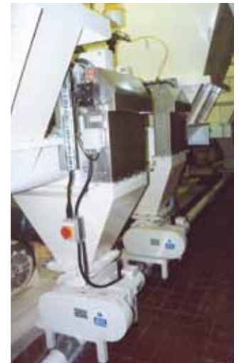
Blow-through rotary valve and pneumatic conveying system Durchblassechleuse und pneumatische Förderung Trémie d'écluse rotative pour transport pneumatique Sfilato rotocella con trasporto pneumatico
