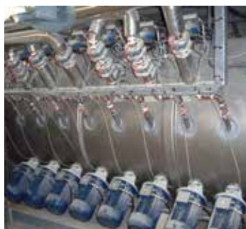
Agitatori, lancia di additivazione liquidi, scambio termico
